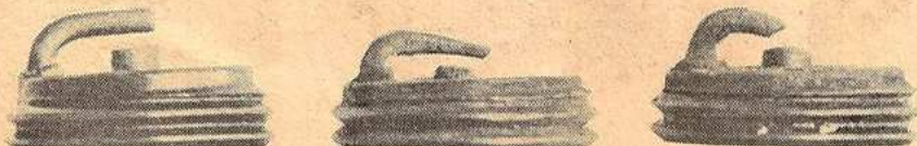
Comparaison entre les électrodes d'une bougie neuve (à gauche) et celles de deux bougies « brûlées ».
